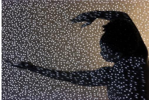
FIGURE 1.13 – Patron infrarouge utilisé par la Kinect (tirée de [44]).
