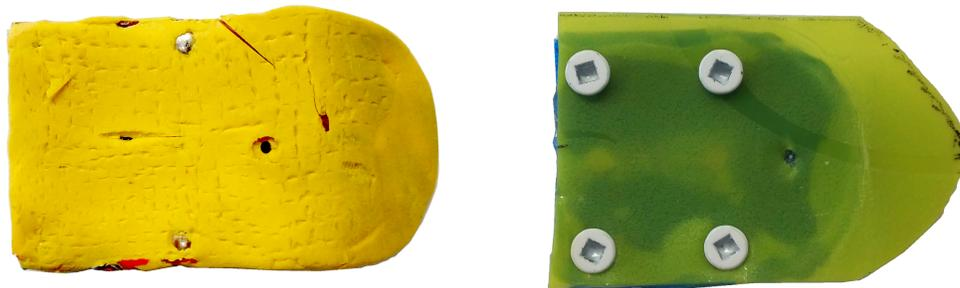
(a) Doigt du dessus - Sugru (caoutchouc) sur feuille de plastique semi-rigide.
