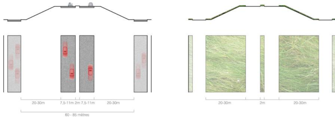
Fig. 31 Configuration de base de l'autoroute sur talus et l'émergence de friches. Source : Jean-Bruno Morissette, 2011.
