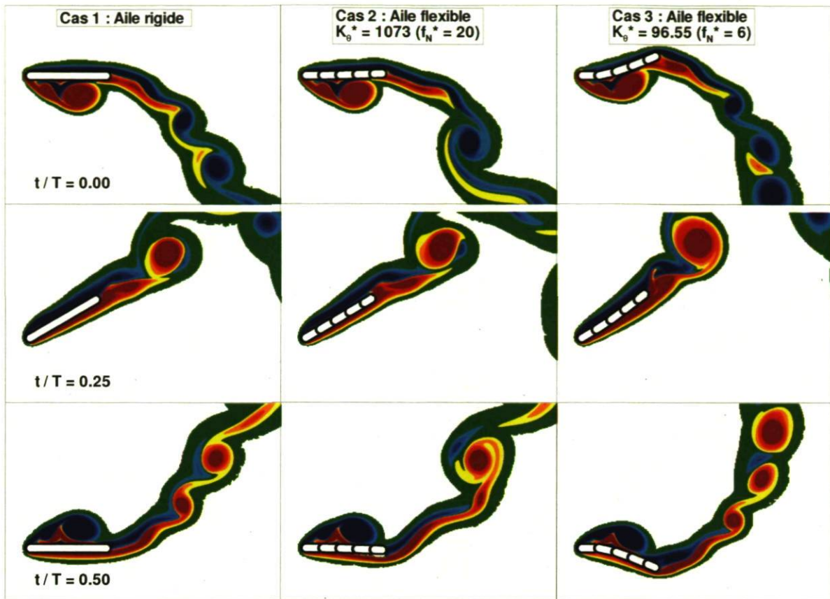
FIG. 5.2 – Champs de vorticité (vorticité positive en rouge; négative en bleu) autour d'une aile oscillante en propulsion à trois instants dans un cycle d'oscillation. Comparaison d'un profil d'aile totalement rigide (à gauche) à deux ailes flexibles ( K_\theta^* = 1073 versus K_\theta^* = 96.55 ); Re = 1000 , f^* = 0.20 , H_0/c = 1 , \alpha_0 = 30^\circ , D^* = 500 , D_\theta^* = 2.13 .
