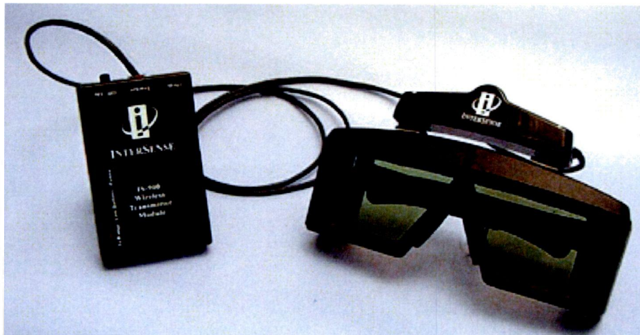
Figure 1-19: Traqueur et module sans-fil du système IS-900
