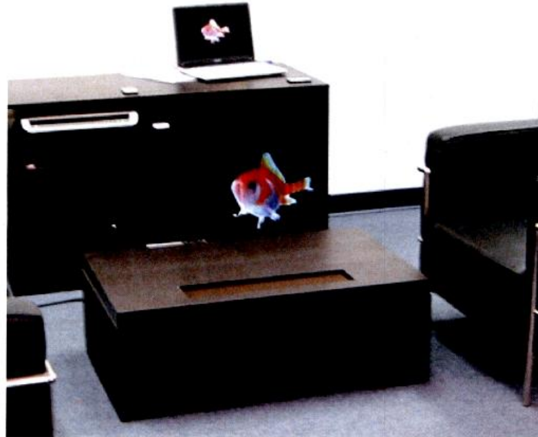
Figure 1-17: Affichage auto-stéréoscopique holographique HelioDisplay M2 de la compagnie IO2
