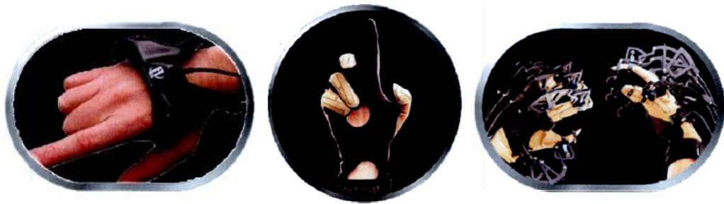
Figure 1-2: Traqueur de main d'InterSense, gant CyberGlove et mécanisme CyberGrasp utilisés au LIV d'anneaux reliés par un câble à des actionneurs. Présentés dans la Figure 1-2, ces trois périphériques combinés permettent de simuler la plate-forme NELI. En effet, la position du pied est déterminée à l'aide du système IS-900 et du gant CyberGlove®. Puis, le retour de force induit par la collision avec le sol peut être simulé à l'aide du mécanisme CyberGrasp™.
