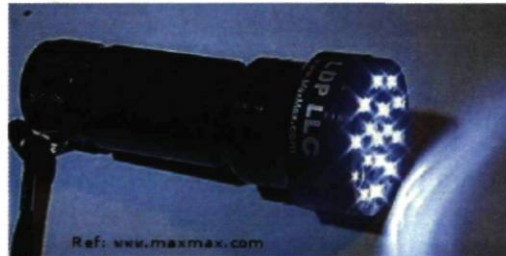
FIGURE 4.6 – Illuminateur infrarouge Flashlight émettant à la longueur d’onde de 850 nm. Il est Composé de 16 LEDs infrarouges, d’une puissance totale de 720 mW.
