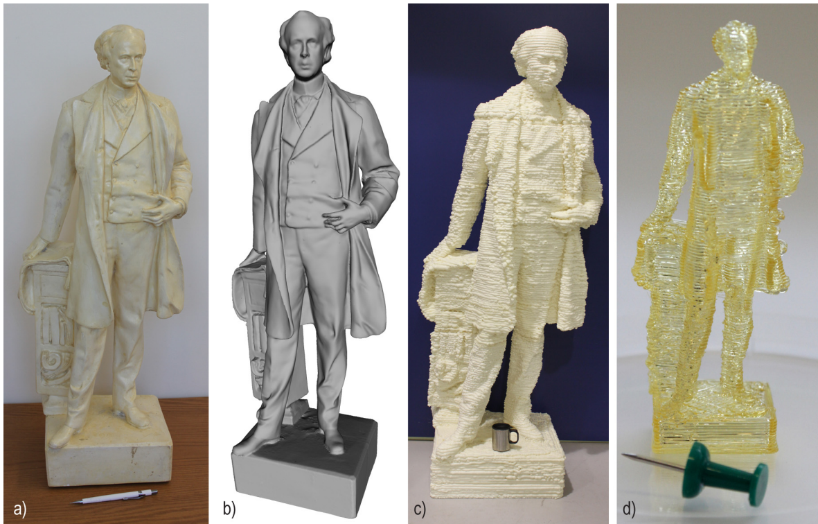
Figure 6.3 : a) La statue originale de sir Wilfrid Laurier en plâtre (Collections d'objets et spécimens de l'Université Laval). b) Rendu du fichier après le balayage numérique (réalisé par le Laboratoire de Vision et de Systèmes numériques de l'Université Laval). c) Reproduction de la statue en mousse de polyuréthane à l'aide d'une imprimante 3D à grande échelle (une gracieuseté du Laboratoire de Robotique de l'Université Laval [56]). d) Reproduction de la statue en sucre vitrifié à l'aide du procédé développé dans ce projet.
