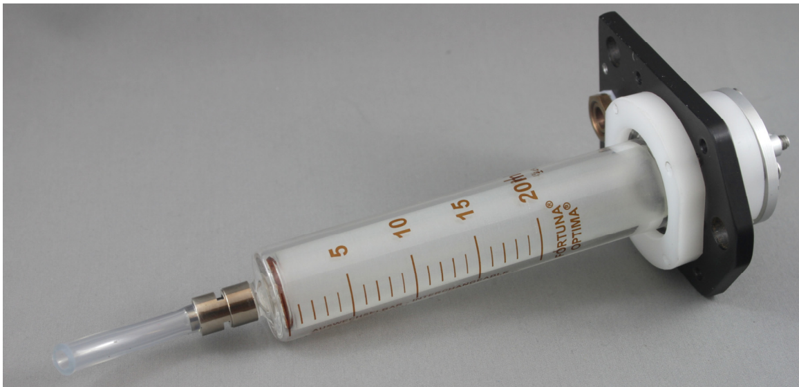
Figure 4.2 : Sous assemblage de la seringue permettant l'aspiration du sirop.
