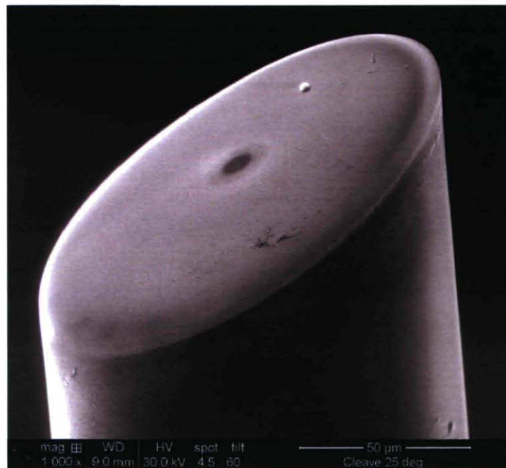
Figure 4.10 – Vue au microscope à balayage électronique d'une fibre optique de silice clivée à 25^\circ
