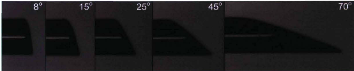
Figure 4.9 – Visualisation de fibres clivées au laser à différents angles
