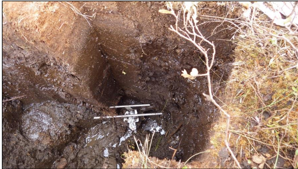
Figure 8: Vue en profondeur de l'échantillonnage des sédiments à l'aide du carottier Box.
