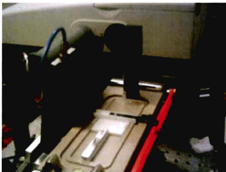
Figure 21 : Montage expérimental du bain de PEEK utilisé lors des mesures d'adsorption de la recoverine à aire fixe.
