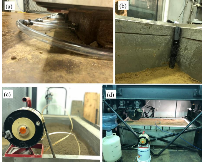
Figure 6.1: a) Tubes de saturation, b) tube perforé pour détecteur de niveau d'eau, c) Capteur de niveau d'eau et d) Système de saturation sur la fosse
