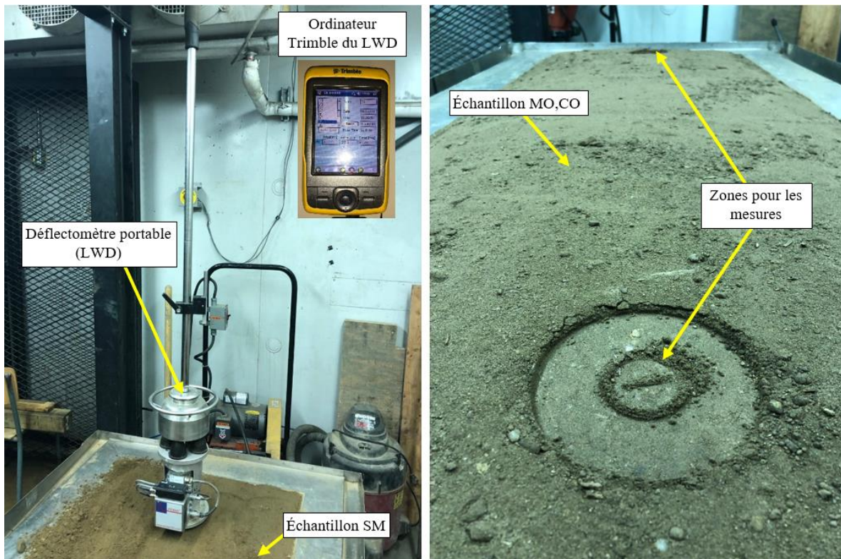
Figure 4.14: Déflexomètre portable (LWD) et Zones pour les mesures sur l'échantillon MO,CO
