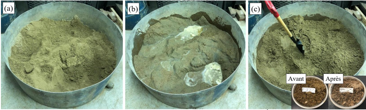
Figure 4.7: Préparation de la couche SP pour les essais sur simulateur a) Échantillon initial , b) Ajout d'eau pour atteindre la teneur en eau visée et c) Mélange homogène du sol SP et obtention de la teneur en eau finale de la couche.
