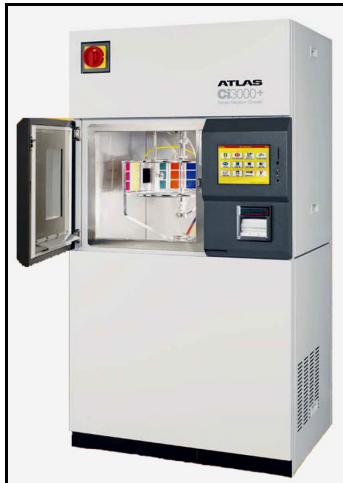
Figure 2.12. La chambre de vieillissement artificiel (WeatherOmeter) Atlas Ci3000+ (Atlas Electric Devices Company)
