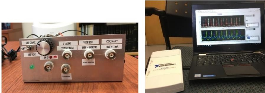
**Figure 1.21 :** Photographie du système d'appareils de mesure et de l'ordinateur. L'image de gauche est une unité de contrôle électronique capable de préparer la tension requise du moteur. De plus, il est responsable de la supervision, de la régulation et de la modification des signaux émis par le système. Cette unité est connectée au système DAQ (le côté droit) avec les câbles pour plus de filtration. Le modèle de périphérique DAQ est USB-6211 avec une résolution de 16 bits.
