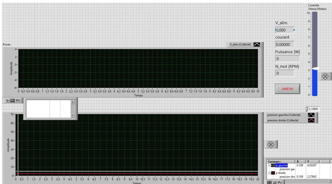
**Figure 1.22 :** Face avant du programme LabVIEW. Sur la face avant, il est possible de lancer le programme et de voir l'évolution de la puissance, de la pression et de la température sur chaque graphique.
