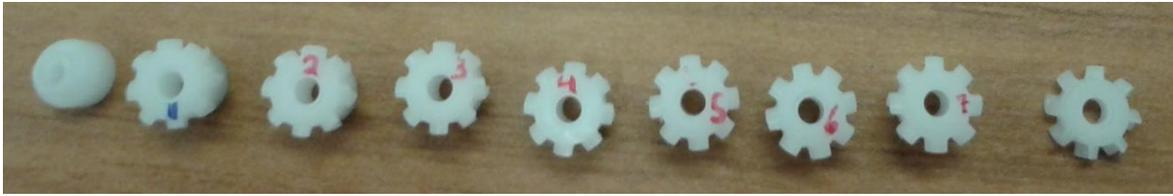
**Figure 1.7** : Huit étages de rotor préparé par usinage.
