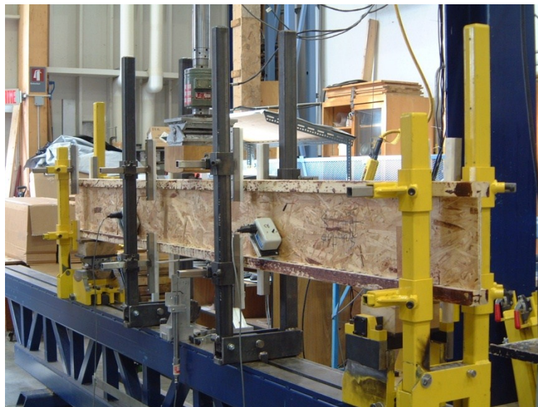
Figure A1.2: Dispositif d'essai en flexion pour poutrelle courte sensible au cisaillement à un point de chargement central.
