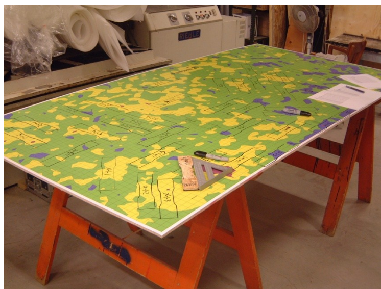
Figure A1.4 : Panneau OSB recouvert de la cartographie horizontale de sa masse volumique . Des échantillons à être découpés ont été dessinés dans des zones de masse volumique homogène.
