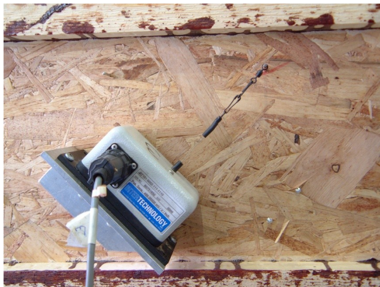
Figure A1.3: Transducteur d'extension à câble PT 101 d'Intertechnology utilisé pour mesurer les déformations axiales à 45^\circ dans l'âme des poutrelles en I lors d'essais en flexion.
