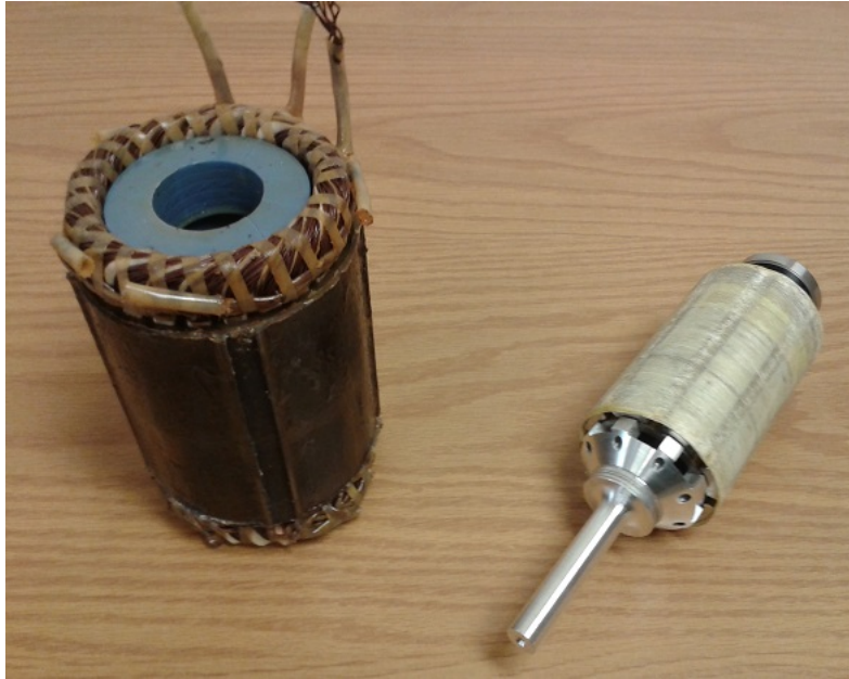
FIGURE 6.8 – Stator bobiné et imprégné de vernis haute température à côté du rotor du moteur prototype
