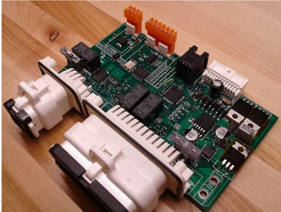
FIGURE 6.27 – Circuit maître de surveillance des cellules
