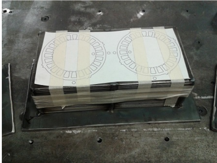
FIGURE 6.6 – Empilement de tôles prêt pour la découpe par électro-érosion.
