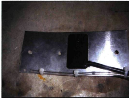
Figure 16 - Plaque de sondes (bulleur et sonde ultrasonique de vitesse) installée en conduite
