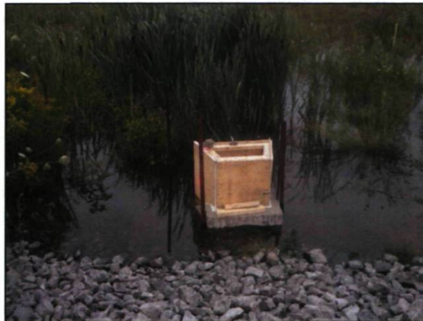
Figure 20 – Montée du niveau d'eau suite à un orage avec sortie fermée
