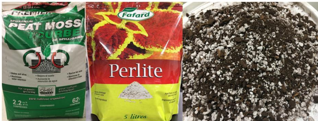
Figure A. 4 : Mélange du milieu filtrant, tourbe et perlite.
