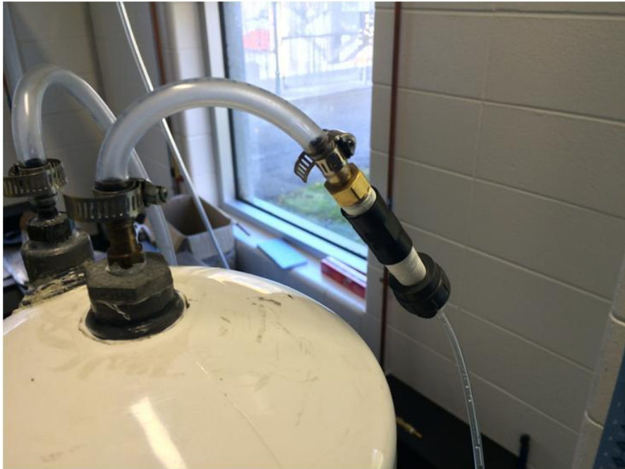
Figure A. 9 : Entrée de liquide et sortie de gaz. Adaptation du diamètre de tube d'alimentation de liquide pour brancher au biofiltre.
