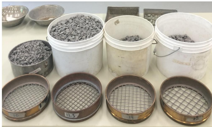
Figure A. 5 : Tamisage de la couche de gravier ajouté sur le plénum, au bas du biofiltre.
