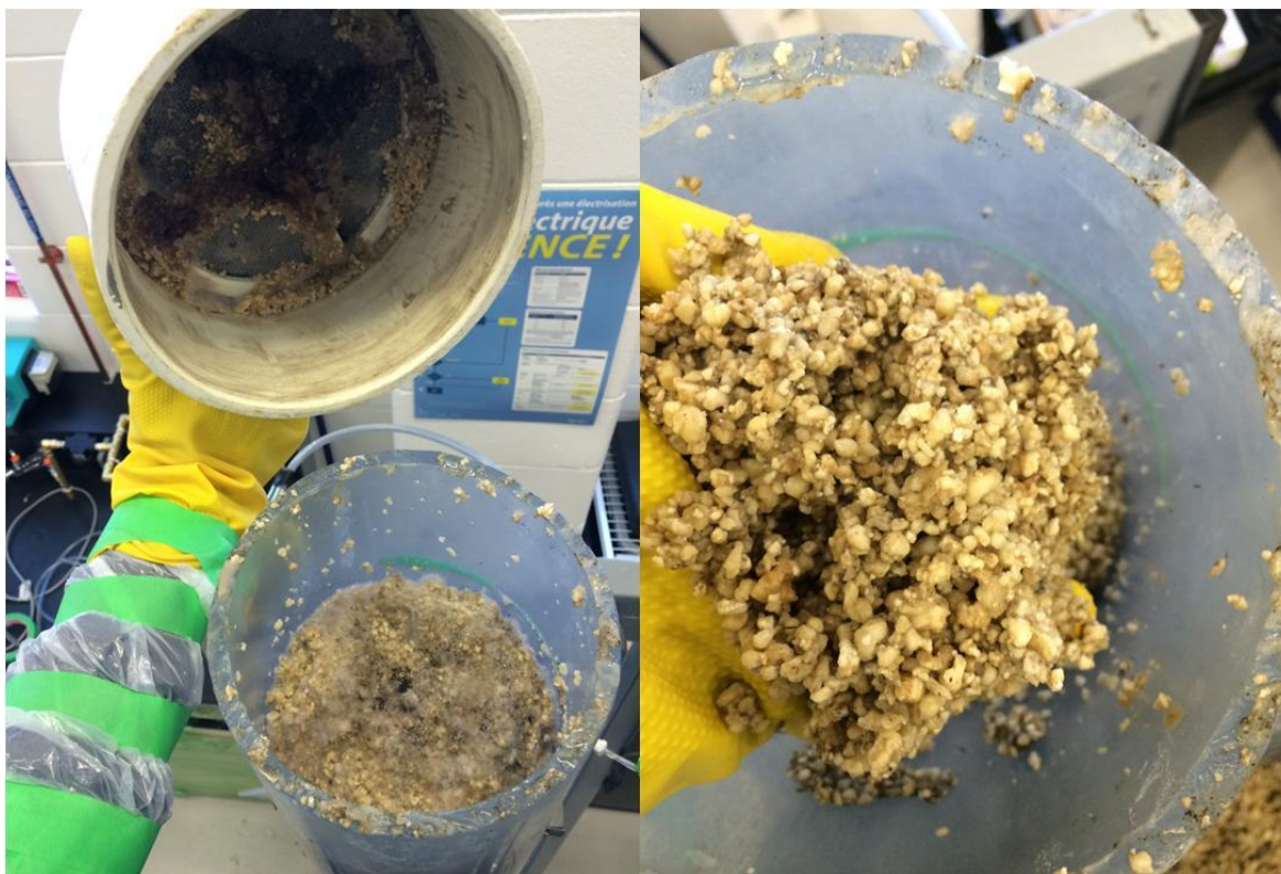
Figure A. 16 : Échantillonnage du milieu filtrant à la fin des expériences.
