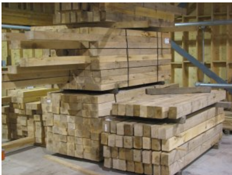
Figure 16 : Blocs de 4x6 d'érable à sucre
