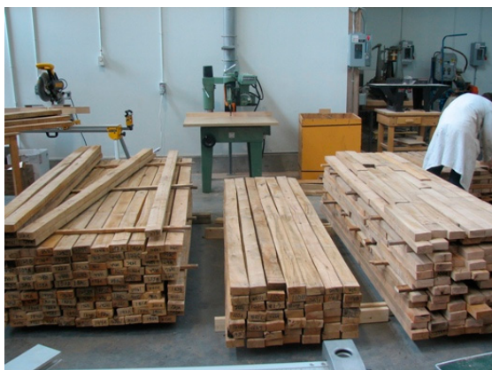
Pièces de 2x4 séchées pour l'éboutage final
