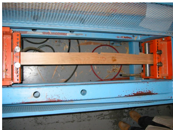
Essai de traction parallèle au grain
