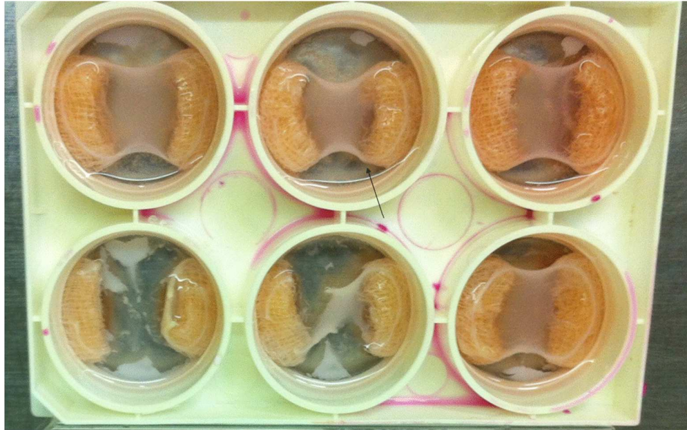
Figure 26: Macrophotographie de gels de collagène avec PSMCs ancrés par une gaze stérile collée à la membrane et la concentration de contrainte que la compaction cellulaire exerce (indiqué par la flèche). Chacun des puits possède un diamètre de 35 mm.
