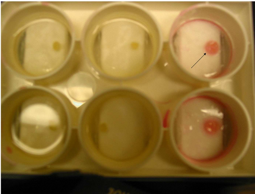
Figure 25: Macrophotographie de la compaction des gels de collagène avec des PSMC après 4 jours de stimulation mécanique dynamique (indiquée par la flèche). Chacun des puits ont un diamètre de 35 mm.
