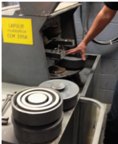
Figure 25: Protocole des laboratoires des mines partenaires. A) Exemple d'entreposage des échantillons sur les pannes en acier inoxydable. B) Instruments permettant de broyer les échantillons. C) Instruments de type Rotary. D) Pulvérisation des échantillons anneau. E) Pulpes obtenues.
