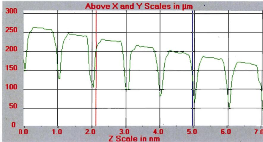
Figure 2. 12 : Coupe de l'image en deux dimensions d'un réseau à profil rectangulaire de période 1.038  $\mu\text{m}$  transféré dans du verre par le procédé de gravure par plasma.
