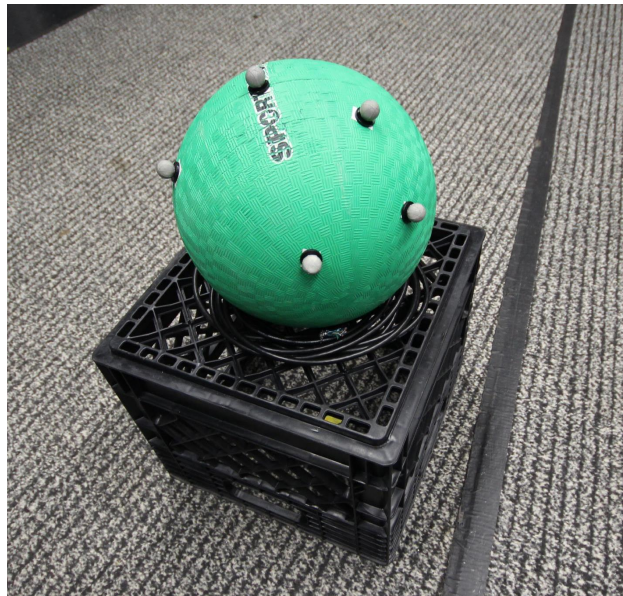
Figure 3.4 – Objet utilisé pour la calibration entre le système de vision développé et le système de suivi de marqueurs Vicon.
