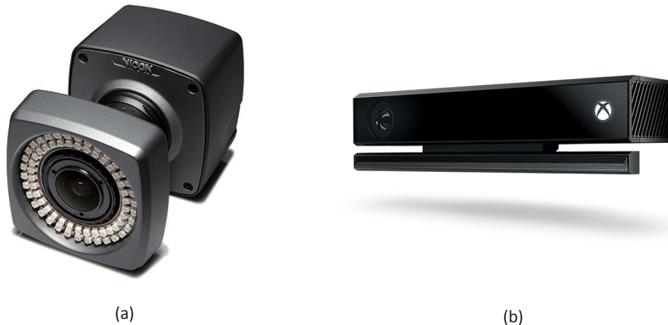
Figure 3.3 – Capteurs utilisés pour l'acquisition de données. (a) Caméra Vicon Bonita [58]. (b) Capteur Kinect V2 de Microsoft [59].
