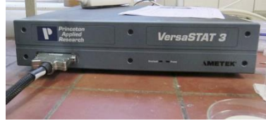
Fig. 21. VersaSTAT3 Potentiostat -Galvanostat workstation
