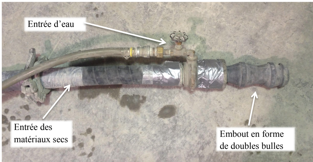
Figure 3.3 : Lance courte et embout en forme de doubles bulles
