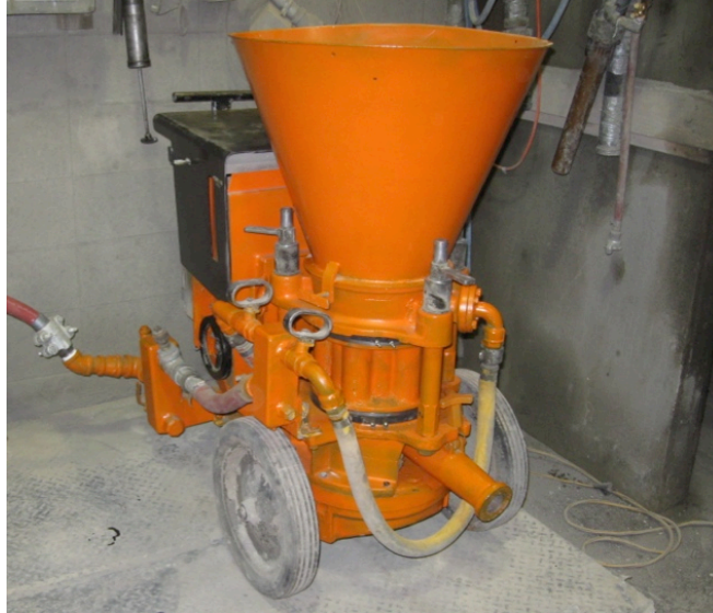
Figure 3.1 : Machine de projection par voie sèche de l'université Laval (Bolduc 2009)
