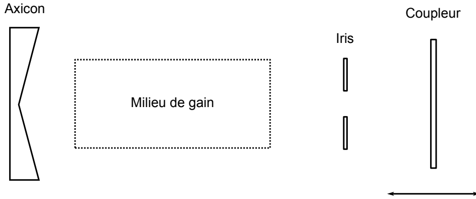
FIGURE 0.4: Schéma du résonateur utilisé par l'équipe de Rioux. Un laser à \text{CO}_2 est utilisé comme milieu de gain. En variant l'ouverture de l'iris et en déplaçant le coupleur, il est possible de faire une sélection des modes d'oscillation supportés par la cavité.
