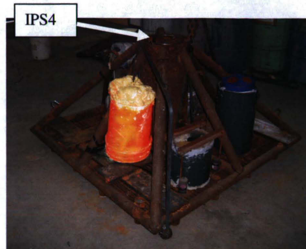
Figure 15 – Pyramide d'instrumentation posée au fond du fleuve près du quai, au port de Québec
