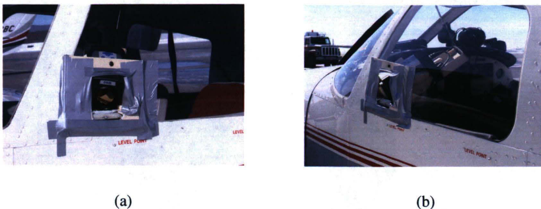
Figure 5 - Position de la caméra thermique à 45°(a et b)
