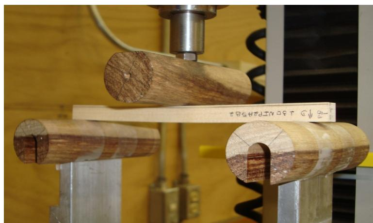
**Figure 2.9 Vue du dispositif pour l'essai de flexion statique.**
