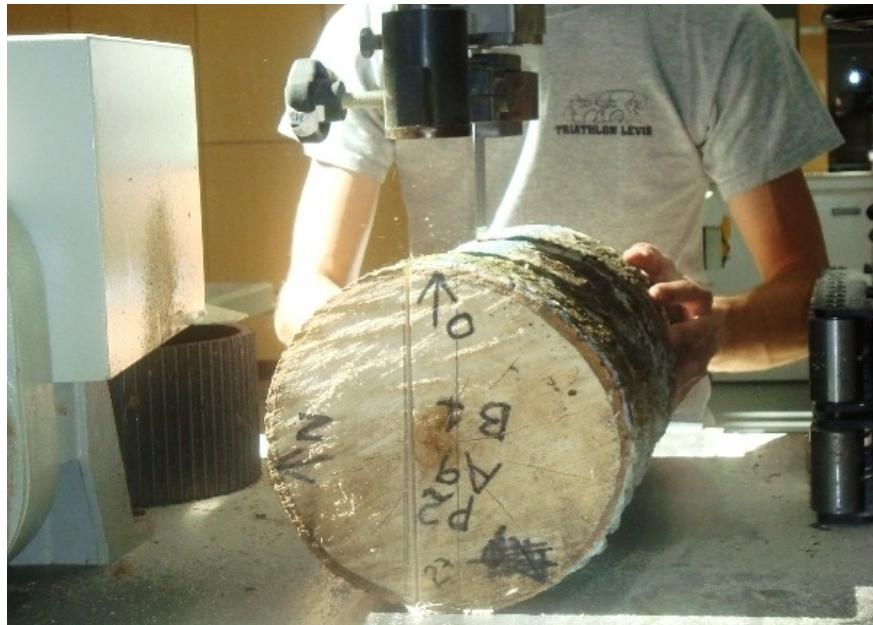
**Figure 2.5 Découpage des planches sur quartier à 30 mm d'épaisseur.**
