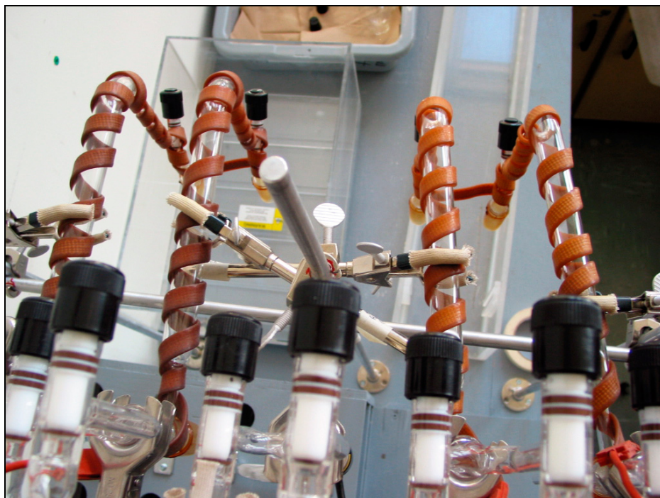
Photographie 5. Rubans chauffants (vue de dessus).
