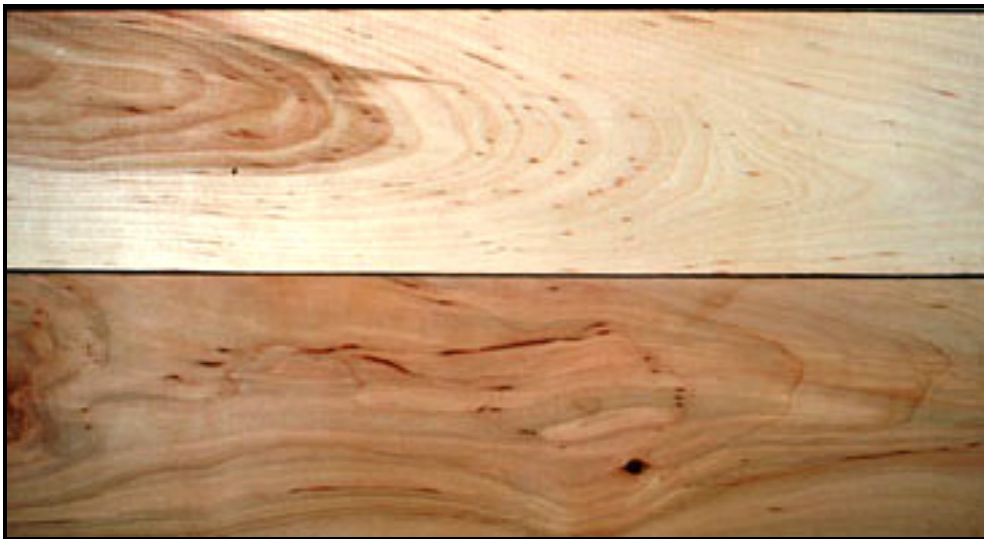
Figure 1.12 Sciages de bouleau avec taches médullaires (d'après Salomon 1995)
