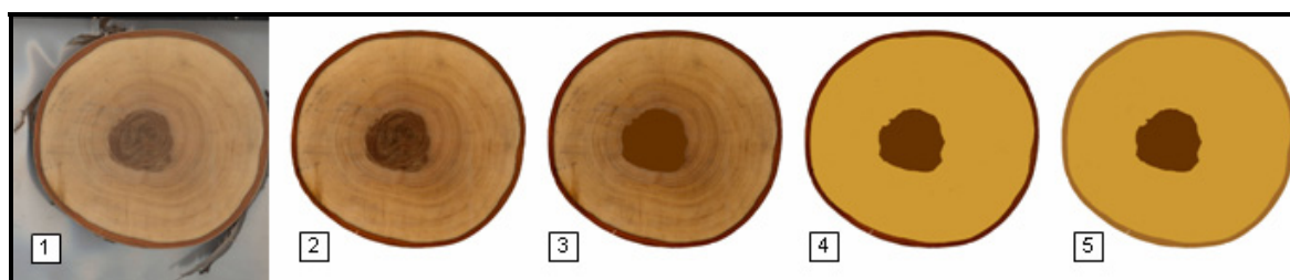
Figure 2.9 Étapes du traitement d'images réalisé avec Photoshop Elements 2
