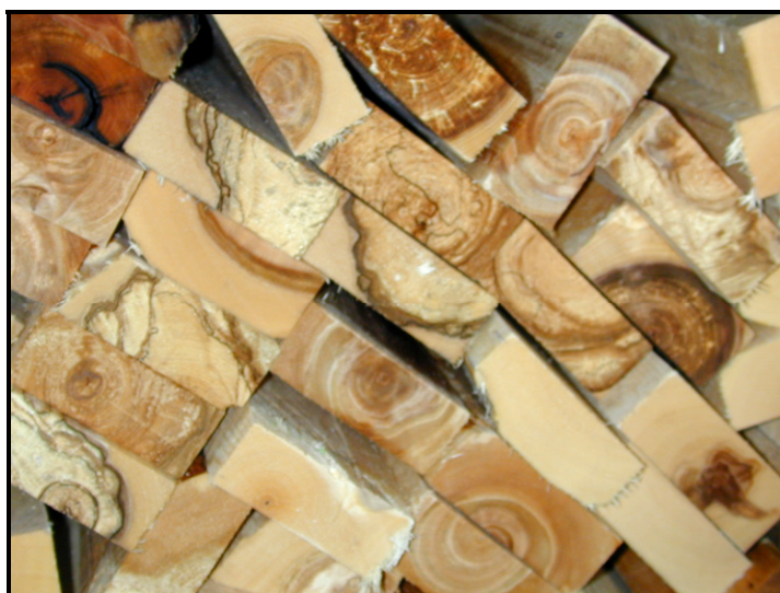
Figure 1.11 Sections transversales de sciages de bouleau à papier présentant des formes diverses d'échauffure et de pourriture, scierie Thomas-Louis Tremblay, Québec
