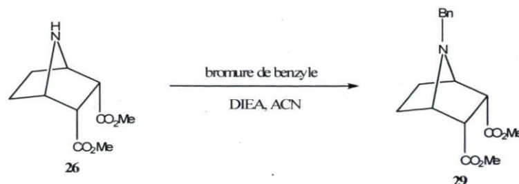
Figure 89 : Préparation du endo diméthyl 7-benzyl-7-azabicyclo[2.2.1]heptane-2,3-dicarboxylate (29)
