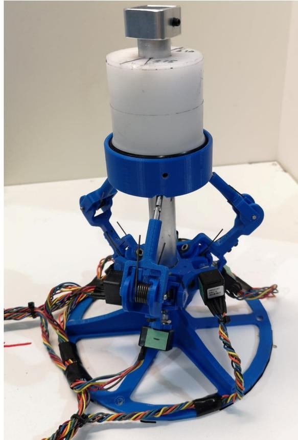
FIGURE 4.3 – Montage utilisé afin de guider le mécanisme pour une trajectoire rectiligne selon l'axe Z.
