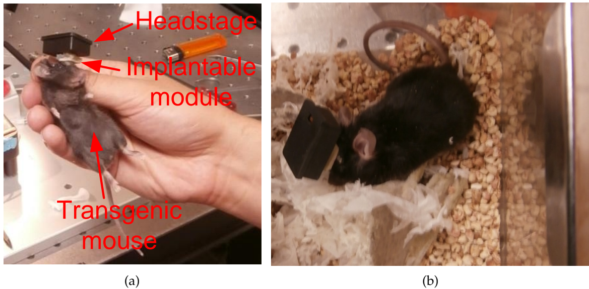
FIGURE 4.24 – a) Souris transgénique anesthésiée avec le module implantable (installé de façon permanente sur le crâne de l’animal) connecté au headstage , b) souris transgénique éveillée en pleine expérience d’enregistrement électrophysiologique avec le headstage .
