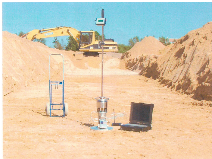
Figure 2.7 : Déflectomètre à masse tombante (D'après Carl Bro et al. , 2006)
