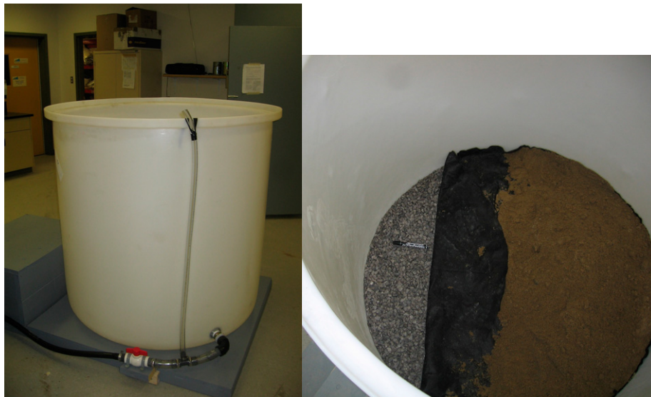
Figure 3.1 : Cuve d'essais et couche de fond
