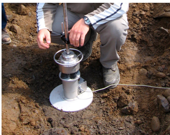
Figure 3.9 : Essai au déflectomètre à masse tombante (sur le terrain)
