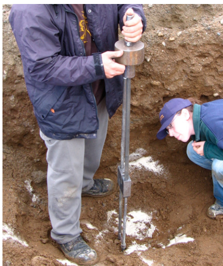
Figure 3.10 : Essai au pénétromètre à cône dynamique
