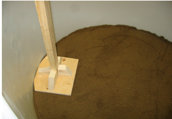
Figure 3.2 : Mise en place du sol avec le pilon de bois
