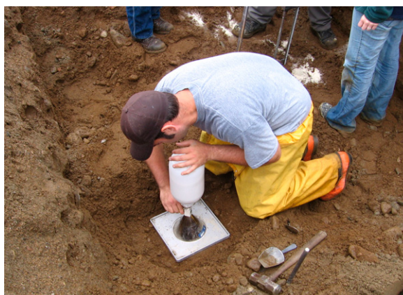
Figure 3.12 : Essai au cône de sable (sur le terrain)
