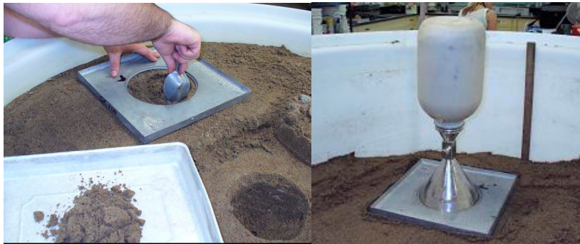
Figure 3.5 : Essai au cône de sable (en laboratoire)
