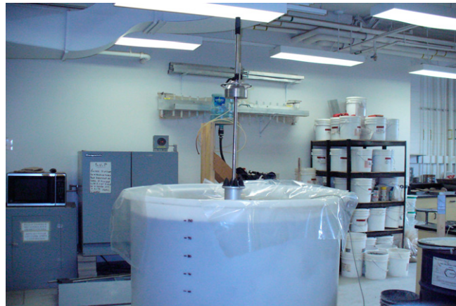
Figure 3.4 : Essai au déflectomètre à masse tombante (en laboratoire)
