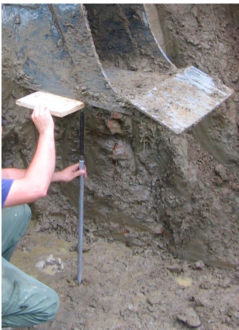
Figure 3.11 : Essai au scissomètre
