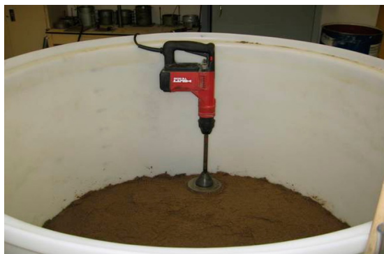
Figure 3.6 : Mise en place du sol avec le marteau vibrant
