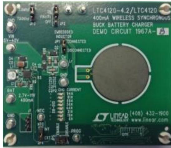
FIGURE 1.13– Le récupérateur d’énergie et chargeur de batterie LTC4120 [70].
