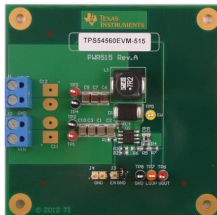
FIGURE 1.12– Carte de développement d'un convertisseur Buck commercial [68].
