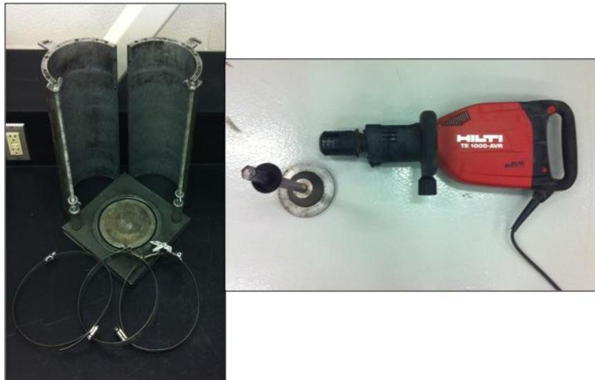
Figure 9-4 : Moule d'acier inoxydable et compacteur à marteau vibrant utilisés pour le moulage de l'échantillon
