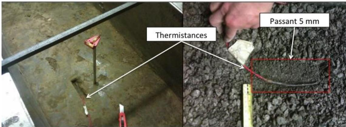
Figure 9-24: Installation des thermistances dans les matériaux à l'essai
