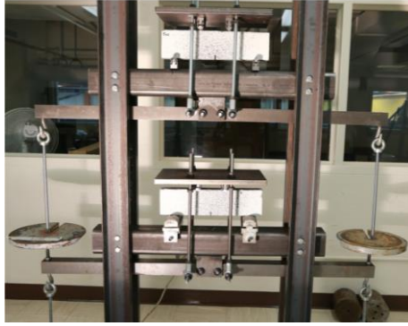
Figure 3.33. Montage expérimental pour les essais de flexion 4 points sur poutre entaillée.
