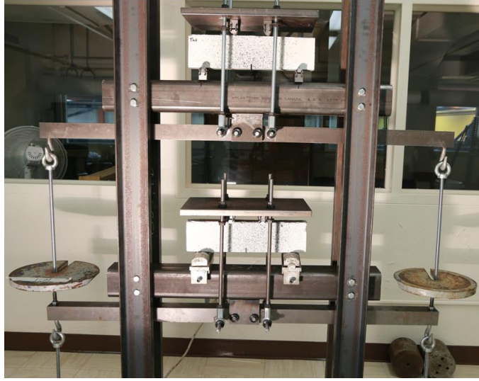
Figure B-9. Montage expérimental pour les essais de flexion 4 points sur poutre entaillée
