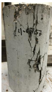
Figure A-2. Mode de rupture lors de l'essai de compression
