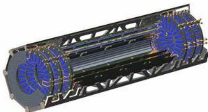
Figura 2.8 - Schema della struttura del rivelatore a pixel.
