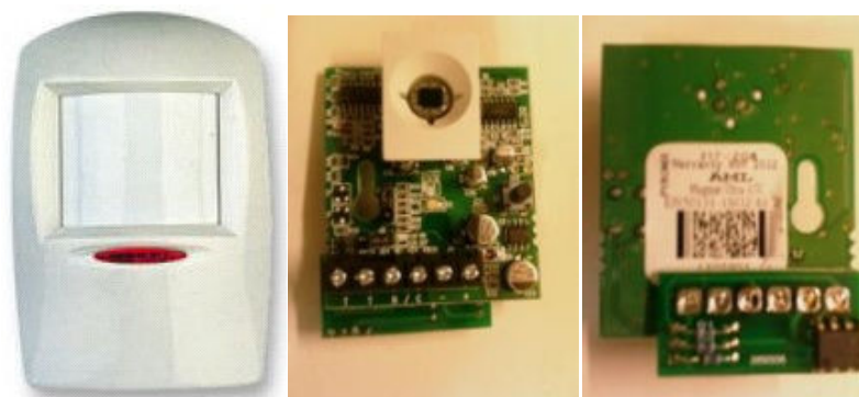
Figure II-3 : Capteur PIR - boîtier, face avant et face arrière avec un PCB secondaire équipé d'opto-coupleurs
