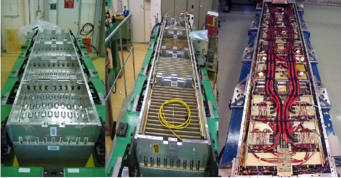
Figura 3.5: Fase di costruzione del supermodulo: a) supermodulo con cristalli b) supermodulo con trigger tower e c) supermodulo completo
