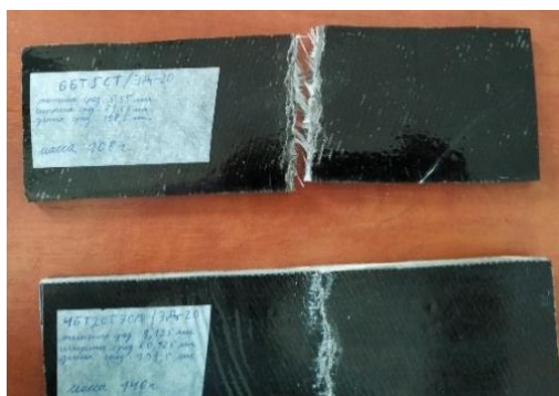
Рис. 5. Результаты разрушения образцов: на растяжение (а), на изгиб (б)
