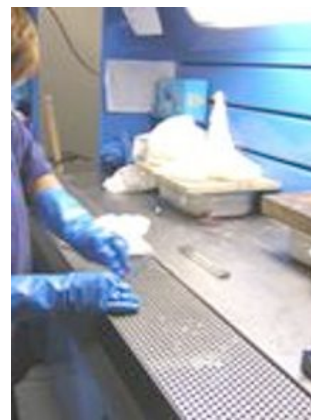
Nettoyage de pièces métalliques par acétone.
