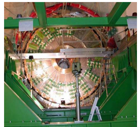
Fig. 12: EM module metrology, EM wheel in the barrel LARG, EMEC wheel in the LARG EC
