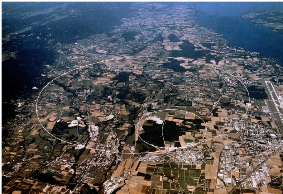
Figura 1: Visione aerea del CERN e della regione circostante. I tre anelli mostrano la posizione sotterranea dell'acceleratore. L'anello più piccolo è il Proto-Sincrotone (PS), quello intermedio è il Super-Proto-Sincrotone (SPS) con una circonferenza di 7 km e l'anello più grande (27 km) è il tunnel che alloggiava il LEP (Large Electron Positron collider) e che conterrà l'LHC (Large Hadron Collider). Sullo sfondo della foto è visibile parte del lago di Ginevra.
