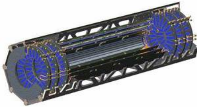
Figura 2.8: Schema della struttura del rivelatore a pixel.
