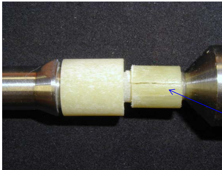
Fissure dans la zone de collage
