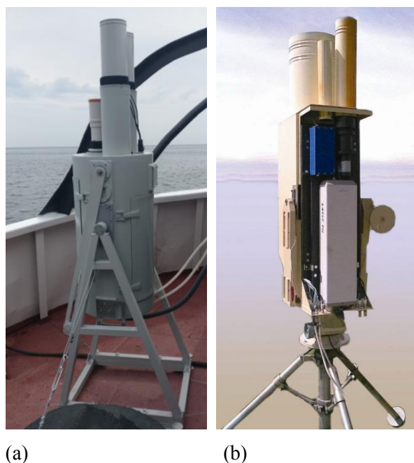
Fig.1 Appearance of mobile aerosol-Raman lidars «LOSA-A2» (a) and «LOSA-M2» (b)
