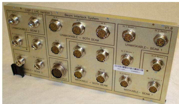
Figure N.10: Front View of the LHC Patch Panel CIBPL
