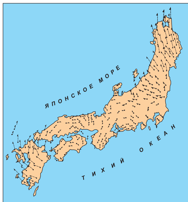
Рис. 1. Векторное изображение смещений триангуляционных пунктов I класса за период приблизительно 60 лет [Рикитакэ, 1970].
