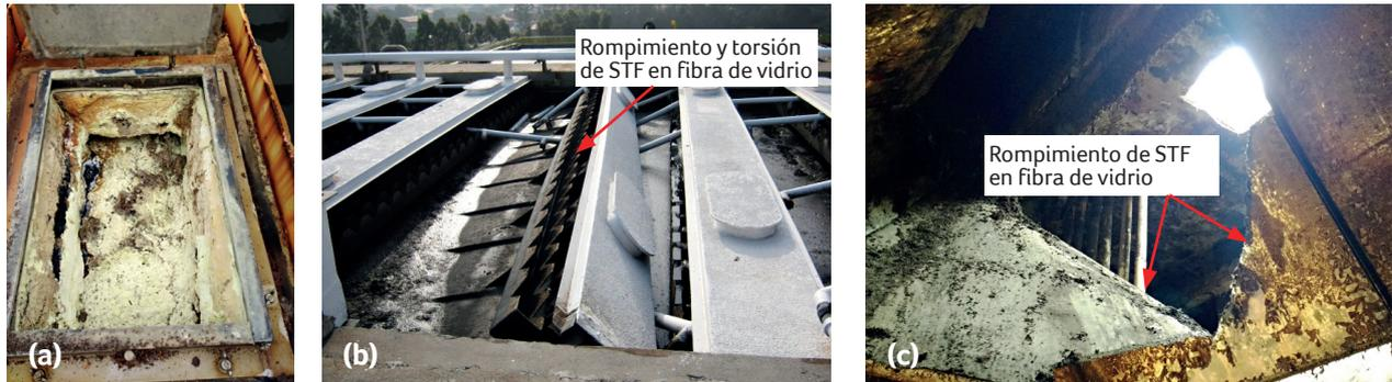
**Figura 11** – (a) Nata solidificada en el interior de un separador trifásico; (b y c) Rompimiento del separador trifásico.
