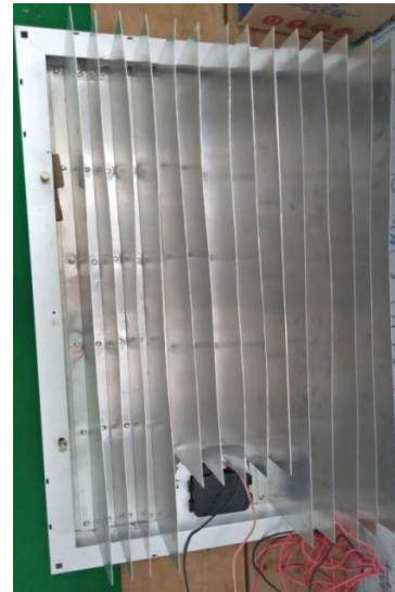
Gambar 8. Heatsink yang dipasang pada bagian bawah panel surya
