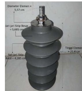
Gambar 1. ZnO arester dengan isolasi polimer
